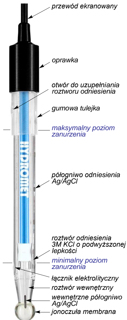
Rys. 1 Elektroda zespolona ERH-AQ1
